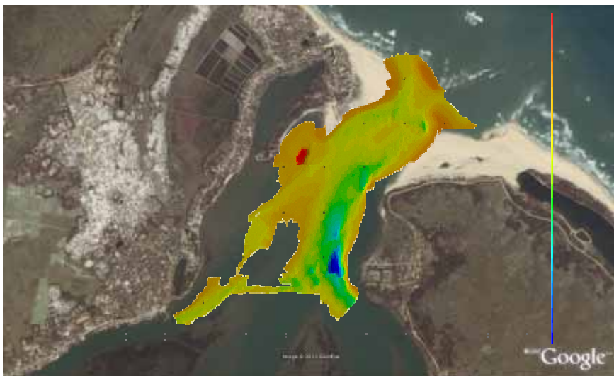
Hình 10 – Một mẫu mô hình địa hình cửa Tư Hiền, chồng lên ảnh vệ tinh đã quy chiếu
