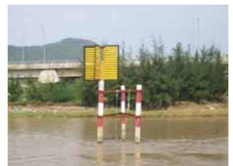
Hình 7 – Tiêu giao thông lắp máy đo dòng nước InterOcean S4. Tiêu này nằm đoạn giữa Thủy Tú, phía bắc Cầu Trường Hà.
