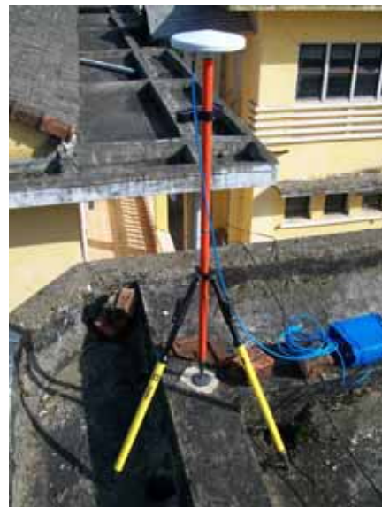
Hình 1 - Antenna GPS hiệu Trimble đang mở, tại một mốc định vị của IMOLA do CGT đặt trên trần văn phòng dự án, nối mạng lưới của GCT với TeMa.
