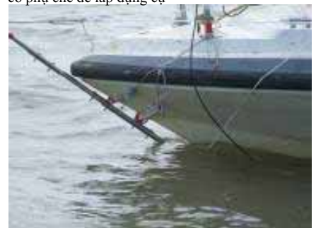
Hình 3 – Máy ADCP lắp vào canoe khảo sát
