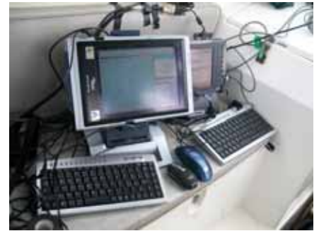
Hình 4 – Bộ điều khiển điện toán kiểm soát bộ phần mềm thủy trắc RESON PDS2000 khảo sát thủy thâm
